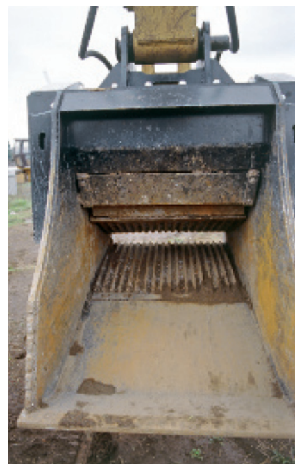
图4: 收集物料的铲斗口部四周有两块侧板(hardox 400)、一个具有“切割”作用的下部(hardox 600)和一个用于安置传动单元的上部。铲口内牢固楔入构件的是破碎钳口(铸铁、锰和碳合金): 这个对物料起到挤压作用的上部, 是单体铸造而成, 避免了使用过程中可能发生的断裂。
