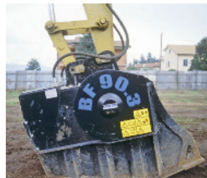
图5: BF 90.3型适用于20吨挖掘机, 是MB-Meccanica Breganzese公司制造的第一个型号的破碎铲斗。重量3.5吨, 开口高度45 cm, 宽度90 cm。所有型号铲斗都是由高强度的材料构成。
