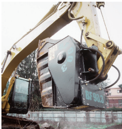
图3: BF 90.3铲斗对指令的反应灵敏、动作灵活, 结构紧凑, 能够快速和简便地挂装在挖掘机臂上, 与其液压管路连接, 这不需对挖掘机械做任何改动。所有型号工作原理都是一样的: 由挖掘机破碎锤(往复)启动。
